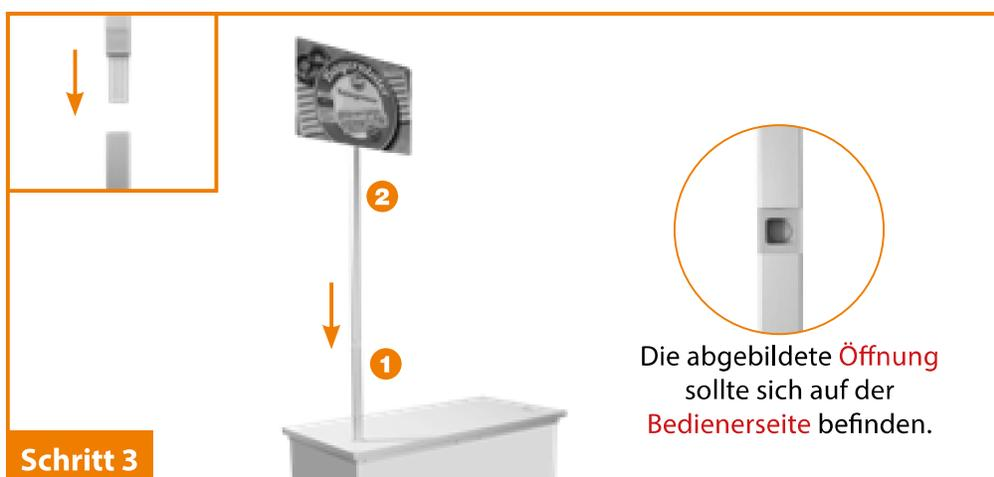
Setzen Sie die **Displaystange 2** (schwarzer Displayhalter nach oben) mit dem **Display** auf die Stange 1.
