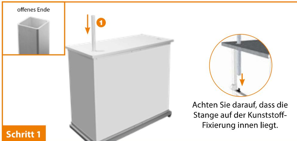
Führen Sie die **Displaystange 1** (ist an beiden Enden offen) in die Öffnung in der Arbeitsplatte ein.
